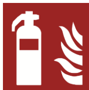
Obrázek – značka s referenčním číslem F001 „hasicí přístroj“
